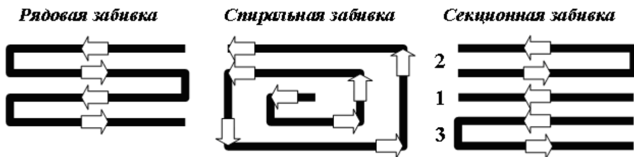
Рис. 3.4. Схемы перемещения копра при погружении свай
