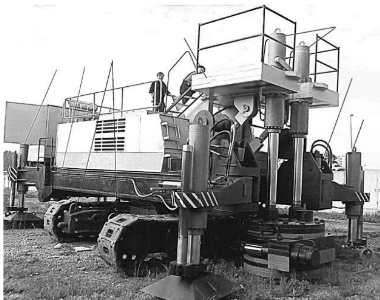
Рис. 3.21. Установка вдавливания свай УВС 160 на гусеничной тележке экскаватора ЭО - 6122
