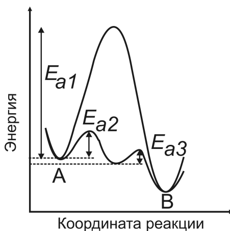
Рис. 35. Схема реакции при гомогенном катализе
