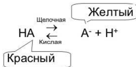
Рис. 54. Принцип действия индикатора
