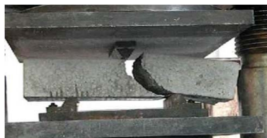
Рисунок 6. Характер разрушения бетонных призм, усиленных углеволокном
