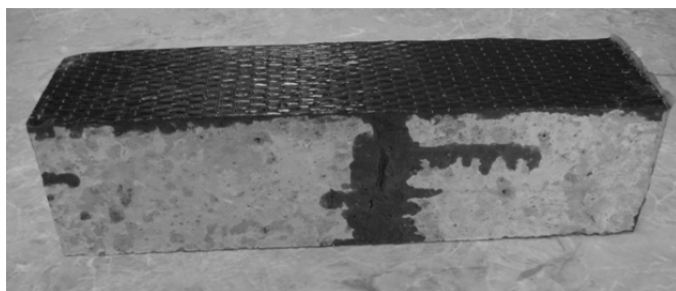
Рисунок 8. Восстановленная и усиленная углеволокном призма
