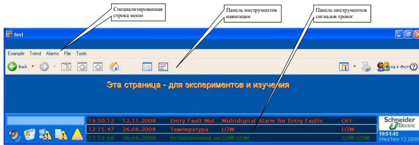
**Рис. 4.1.** Типовой внешний вид графической страницы, основанной на шаблоне **Normal** из включаемого проекта **CSV\_Include**
