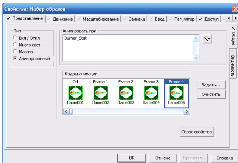
Рис. 4.20. Анимация пламени горелки для объекта **Burner** в графической странице **Oven**
