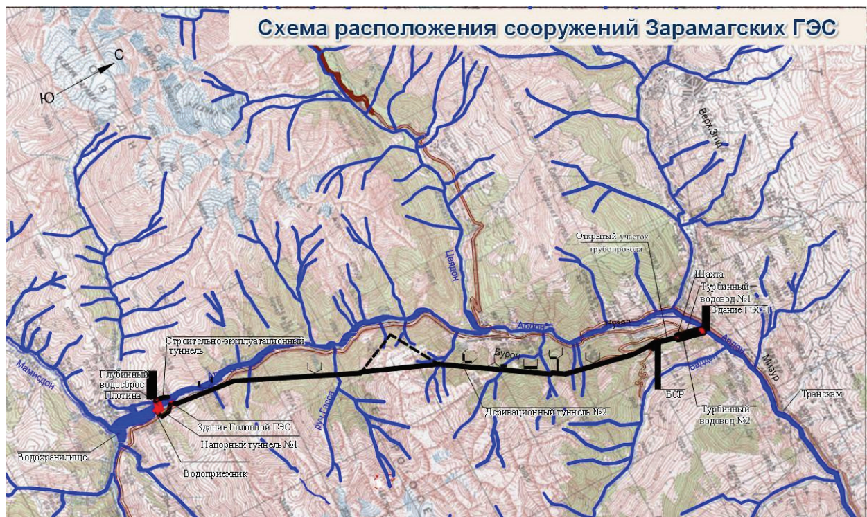
Рисунок 1. Схема расположения сооружений Зарамагских ГЭС
