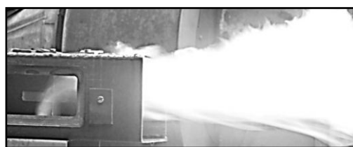
Рисунок 22 – Воспламенение смеси и стабилизация пламени в модельной КС закрученной струей: \bar{v} = 40
