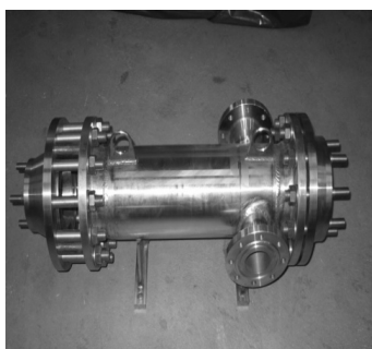
Рисунок 9. Внешний вид высокооборотного электрогенератора турбодетандера
