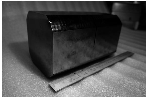
Рис. 4. Рабочий кристалл кремния. Размеры  $\varnothing 150 \times 220$  мм<sup>3</sup>. На половине толщины сделан поперечный разрез для возможности исследования дифракции в двухкристальной схеме.
