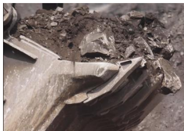
Рис. 7. Полнота заполнения ковша экскаватора горной массой.
