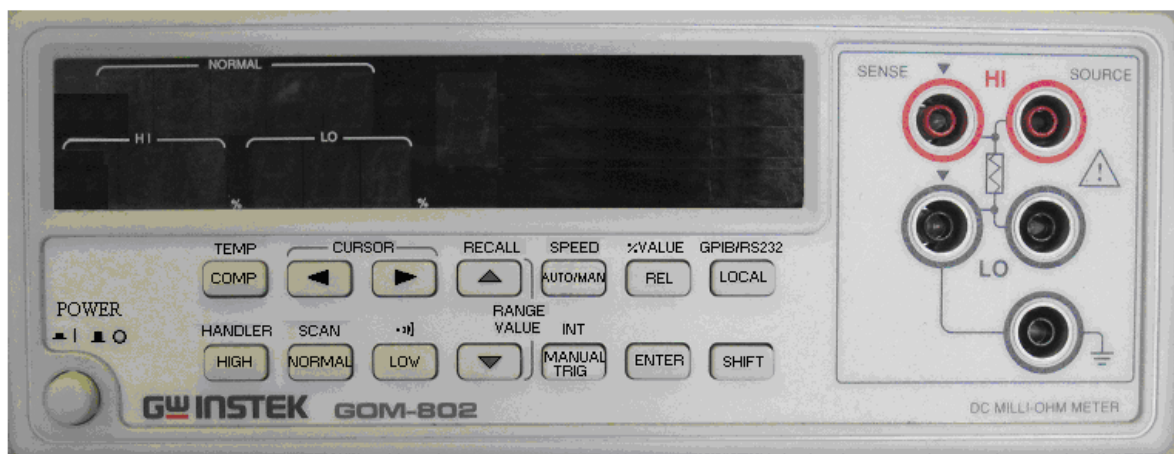
Рис. 3.2. Передняя панель цифрового миллиомметра GOM-802
