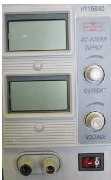
Рис. 3.3. Источник постоянного напряжения
