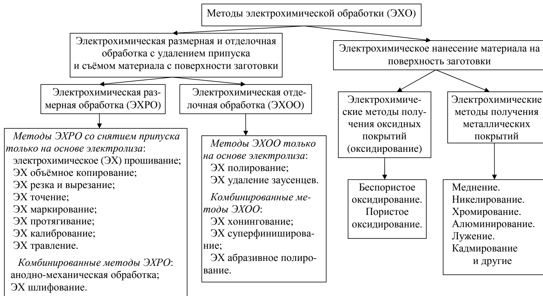
Рис. 4.5. Классификация электрохимических методов обработки 4
