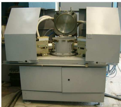
Рис. 5.30. Электрохимический станок ЭХТ-5000 для обработки турбинных лопаток
