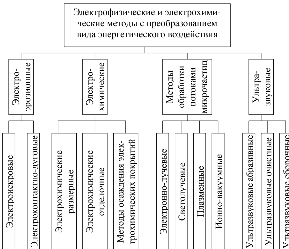
Рис. 1.3. Классификация электрофизических и электрохимических методов обработки, осуществляемых с преобразованием формы энергетического воздействия
