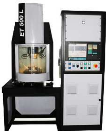
Рис. 5.29. Универсальный электрохимический копировально-прошивочный станок
