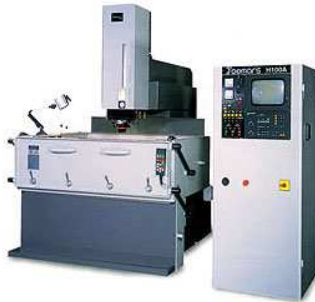
Рис. 2.32. Электроэрозионный копировально-прошивочный станок с ЧПУ компании HEIDENHAIN
