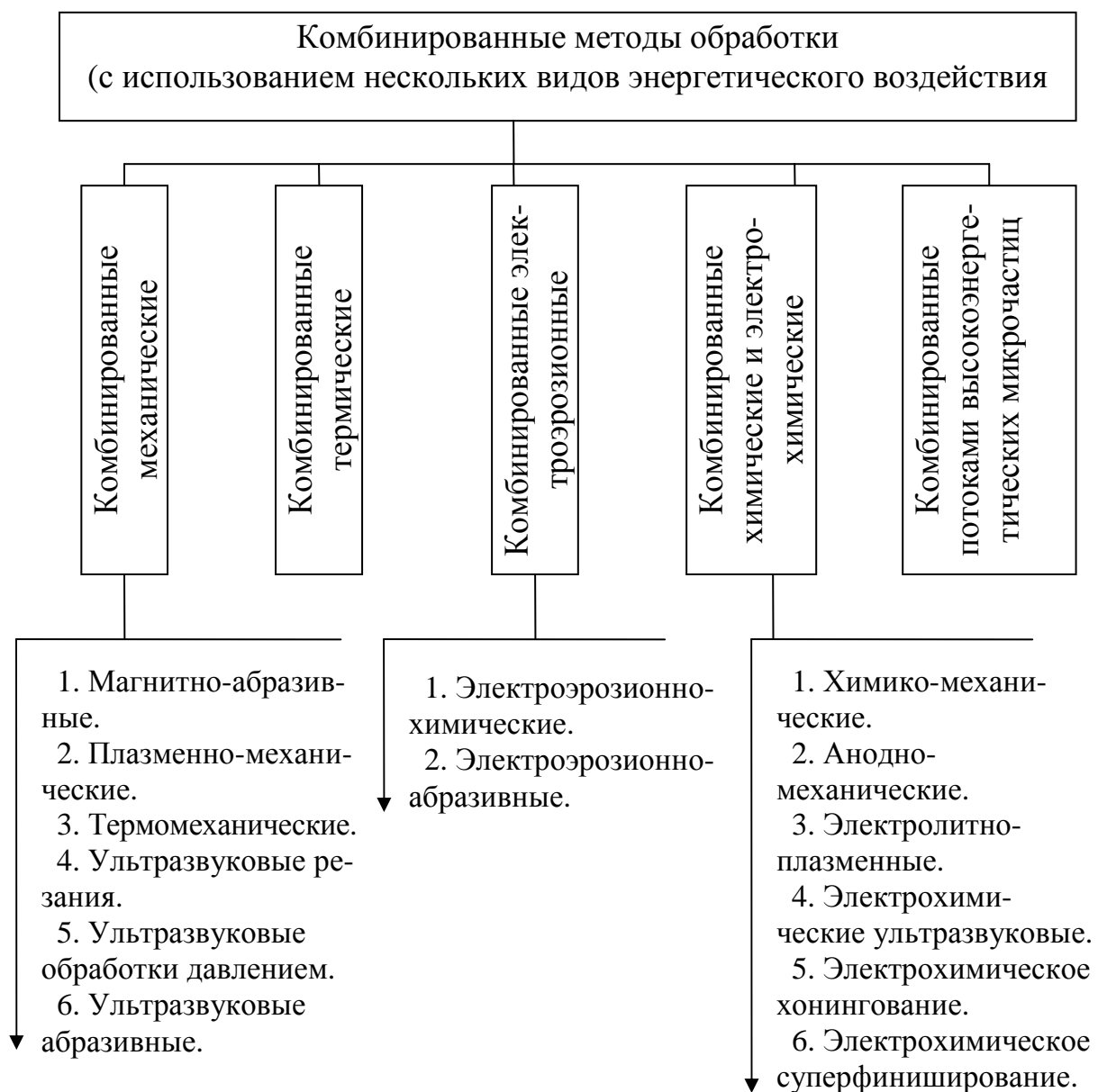
Рис. 1.4. Классификация комбинированных методов обработки
