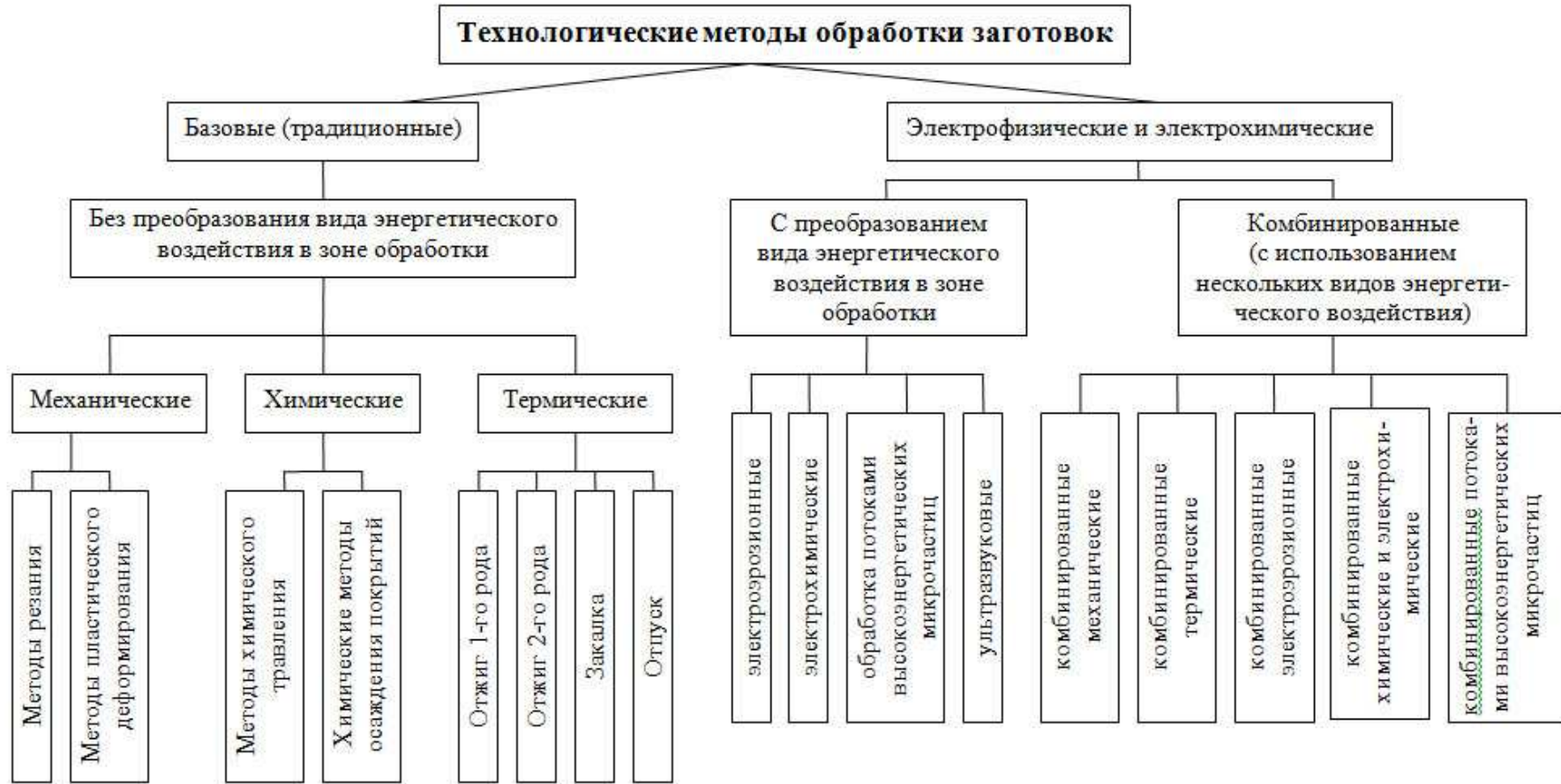
Рис. 1.2. Классификация технологических методов обработки заготовок
