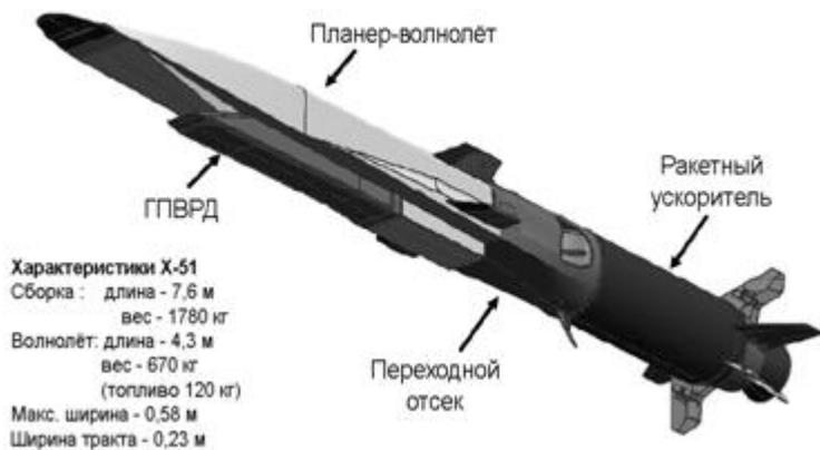
Рис. 1.13. Аппарат X-51A в сборке
