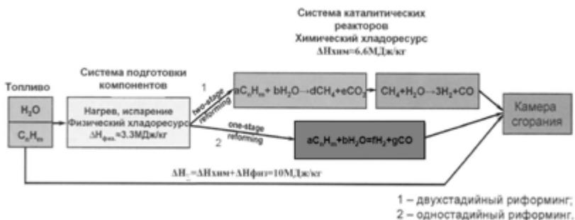
Рис. 1.31. Принципиальная схема преобразования топлива
