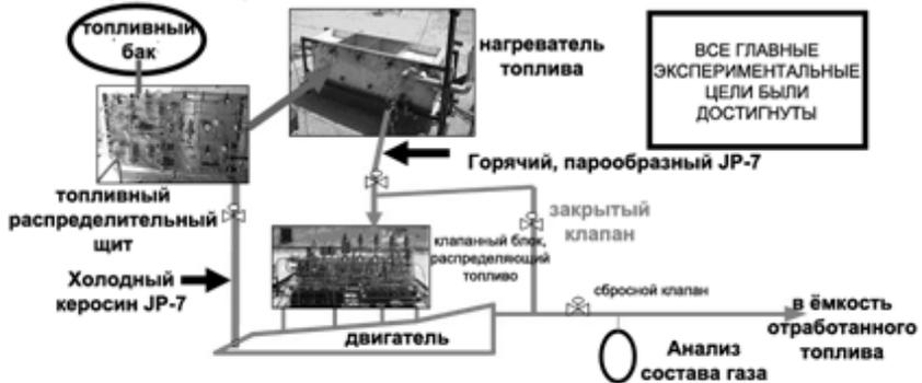
Рис.1.8. Функциональная схема испытаний GDE-1
