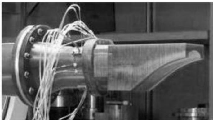
**Рис. 1.21.** Модель сопла на испытательном стенде
