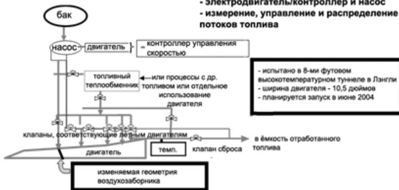
**Рис.1.10.** Функциональная схема испытаний GDE-2
