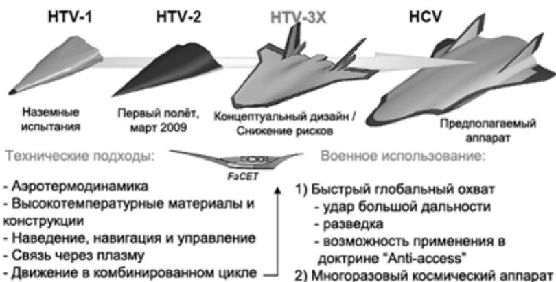
**Рис. 1.16.** Серия аппаратов, разрабатываемых по программе FALCON
