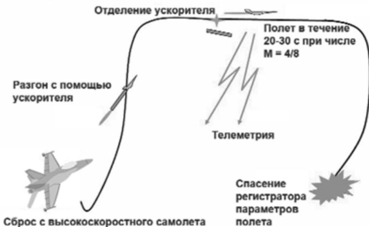
**Рис. 1.23.** План полёта аппарата LEA
