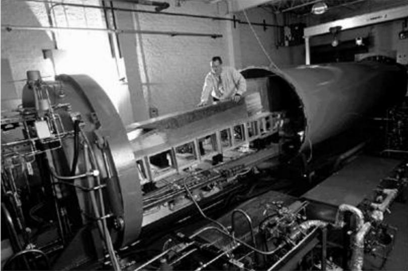
**Рис.1.9.** Стендовые испытания GDE-1 в исследовательском центре GASL
