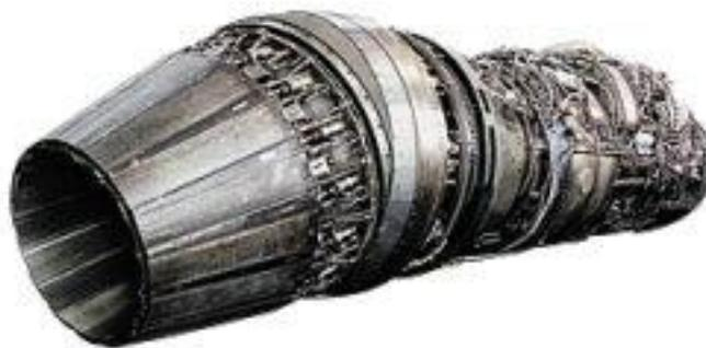
Рис. 5. 22. Поворотное сопло реактивного двигателя самолета
