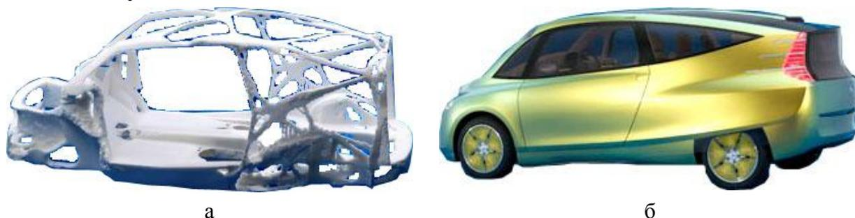
Рис. 5. 14. Концепт автомобиля Bionic-Mercedes: а – компьютерная модель несущей системы, б – внешний вид
