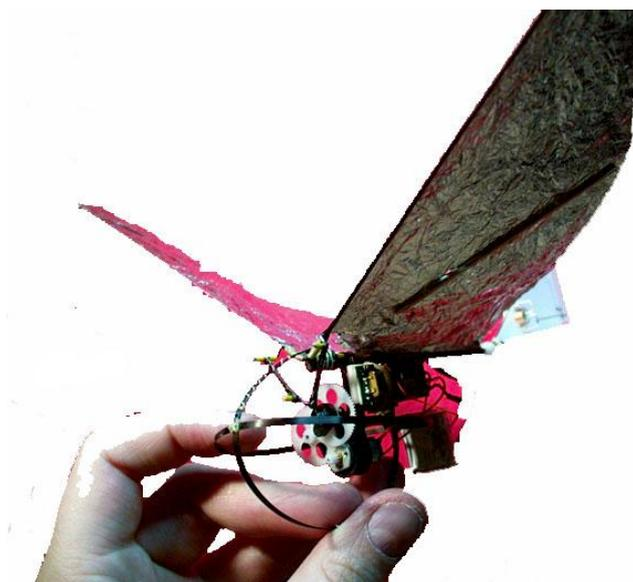
Рис. 5. 35. МЛА с приводом от микроэлектродвигателя
