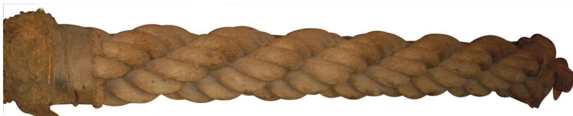
Рис. 4. 43. Пеньковый морской канат диаметром 300 мм
