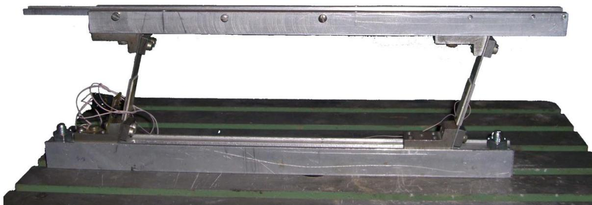
Рис.8.6. Пьезоэлектрический вибрлоток с БПП
