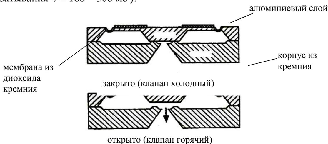
Рис. 1.9. Принцип действия биметаллического микроклапана
