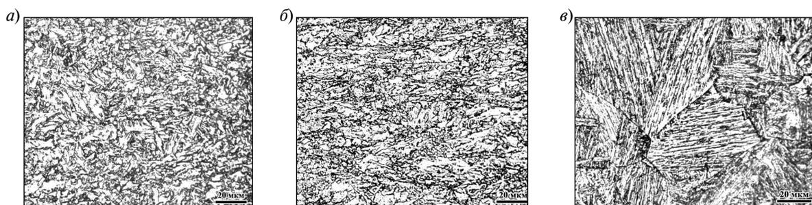
Рис. 5. Структура стали марки К70:
