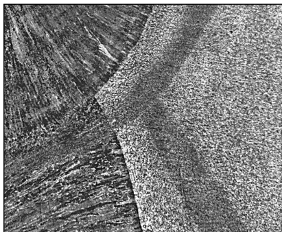
Рис. 1. Сварное соединение трубы при двух проходной многодуговой сварке
