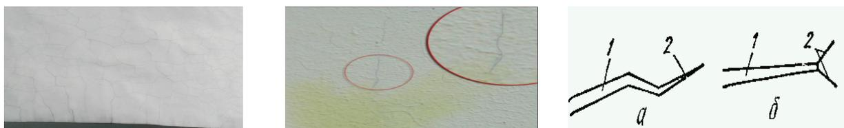
Рисунок 3. Развитие трещин в штукатурном покрытии при эксплуатационных воздействиях
