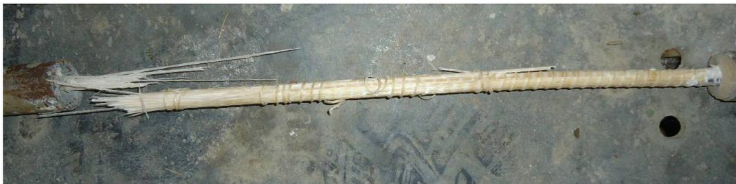
Рисунок 2. Характер разрушения образцов ПКА средних диаметров: отслоение оплетки, после чего происходит разрыв основного стержня
