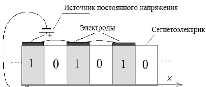
Рисунок 1. Управляемый пьезометаматериал с периодическими структурами, сформированными электрическим полем: 0 – диэлектрическая область, 1 – пьезоэлектрическая область.
