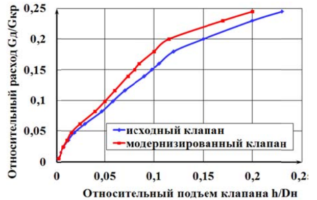
Расходные характеристики регулирующего клапана греющего пара
