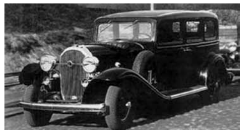
Автомобиль Л-1 (Ленинград-1) – предшественник ЗиС-10 – был выпущен заводом «Красный Путиловец» как экспериментальный. Прототипом послужила модель ВиСК-32-90. В 1933 г. изготовление такой машины было серьезным достижением для промышленности СССР. Руководитель работ – зав. кафедрой 1939-41 гг. Л.В. Клименко.
