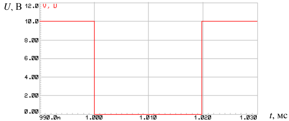
Рис. 2.15. Сигнал на выходе инвертора
