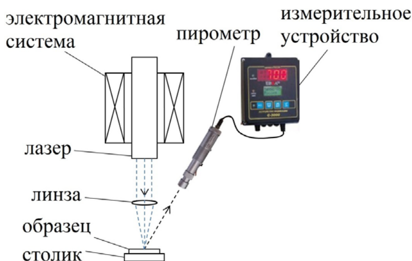
Рис. 3.15. Электротехнологический комплекс для измерения толщины покрытия
