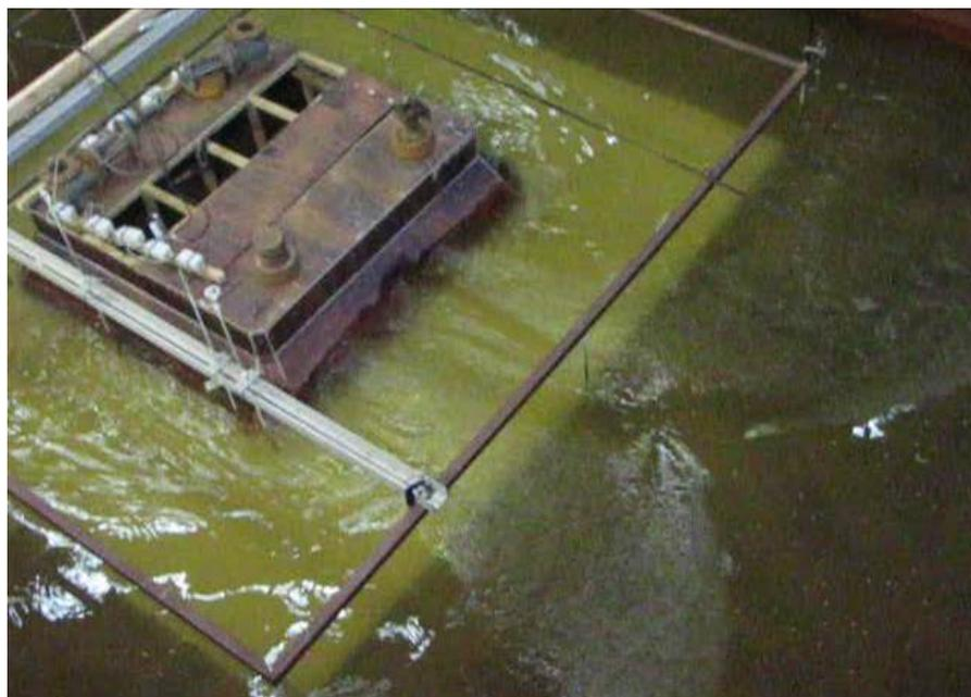
**Рисунок 5. Дифракция одиночной волны в области тыловой части модели МЛСП «Приразломная» (образование волн, идущих вдоль тыловой грани платформы в сторону ее углов) в течение опыта 5**
