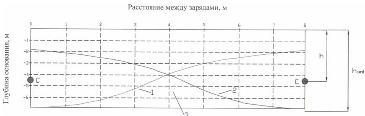
**Рисунок 1. Характер зон разжижения грунта при последовательном взрыве двух расположенных рядом зарядов с интервалом времени  $\Delta t \geq t_{уп}$ :**
