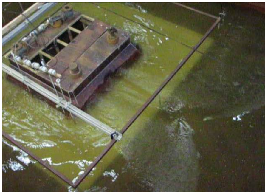
Рисунок 5. Дифракция одиночной волны в области тыловой части модели МЛСП «Приразломная» (образование волн, идущих вдоль тыловой грани платформы в сторону ее углов) в течение опыта 5
