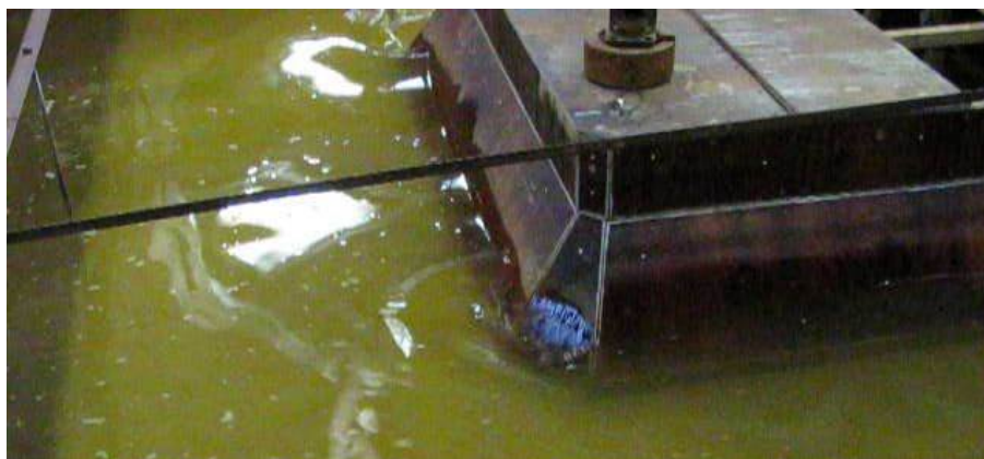
Рисунок 4. Вид со стороны правого борта огибания одиночной волной граней срезаемых углов с тыльной стороны модели МЛСП «Приразломная»: наблюдается понижение уровня воды на гранях срезаемых углов в течение опыта 4
