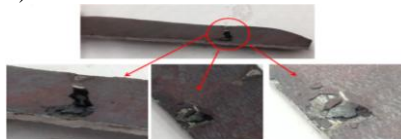
Рис. 6. Исходная сетка конечных элементов с подповерхностными трещинами (а), трансформация дефектов при прокатке в клети №1 стана 2000 (б) и после прокатки в клети №12 стана 2000 (в); образцы после лабораторной прокатки с вытяжкой \lambda=3 (з) и в конечной толщине при вытяжке \lambda=10 (д)
