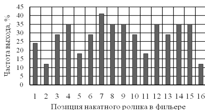
Рисунок 5.2 – Частота выхода накатных роликов из строя
