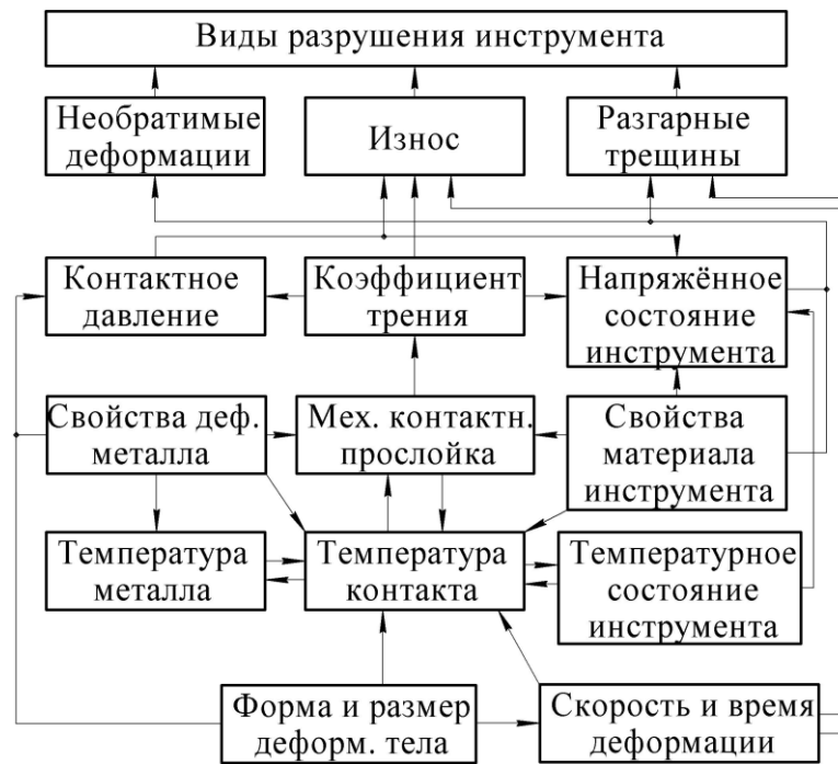
Рисунок 1.2 – Схема доминирующих факторов разрушения инструмента
