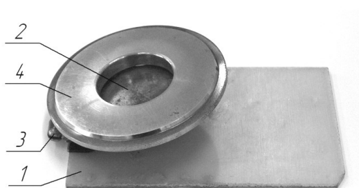
1 – неподвижная плоскость (основание); 2 – подвижная плоскость; 3 – шарнир; 4 – ролик
