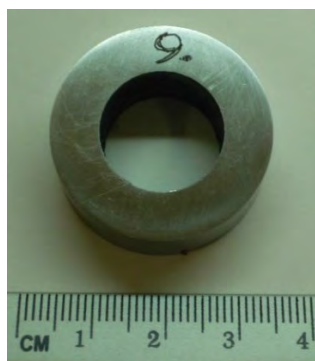
Рисунок 3.10 – Образец ролика Сталь 45 Рисунок 3.11 – Образец колодка Р6М5
