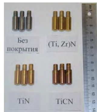
Рисунок 3.10 – Образец ролика Сталь 45 Рисунок 3.11 – Образец колодка Р6М5
