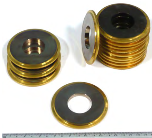
Рисунок 5.1 – Накатные ролики из быстрорежущей стали P6M5 с однослойным многокомпонентным покрытием TiZrN
