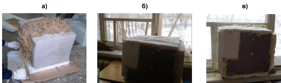
Рисунок 1. Экспериментальный образец многослойной стены: а – общий вид экспериментально образца; б – изоляция утеплителя; в – установка образца в проектное положение
