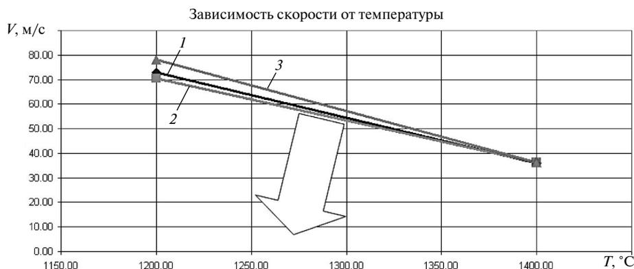
Рис. 12. Области  $(V_i, T_i)$ , в которой значения деформаций ниже заданного допустимого уровня (1 —  $V_4$ ; 2 —  $V_3$ ; 3 —  $V_5$ )
