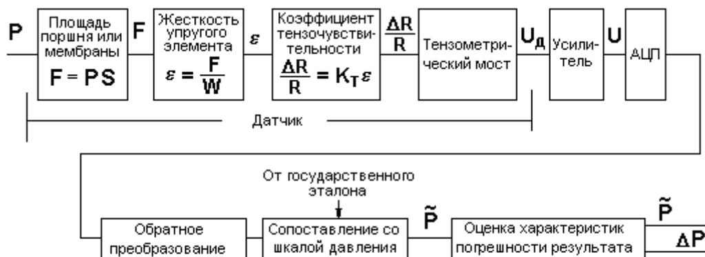
Рис. 25. Измерительные преобразования при измерении давления с помощью тензорезистивного датчика
