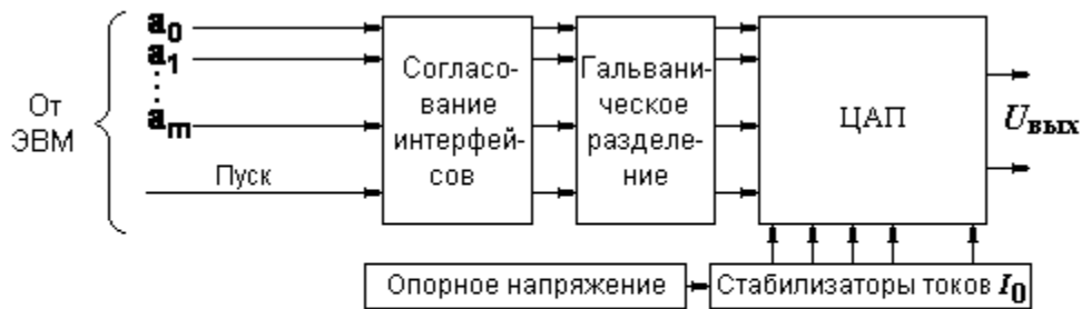
Рис. 44. Состав ЦАП, сопрягаемого с компьютером
