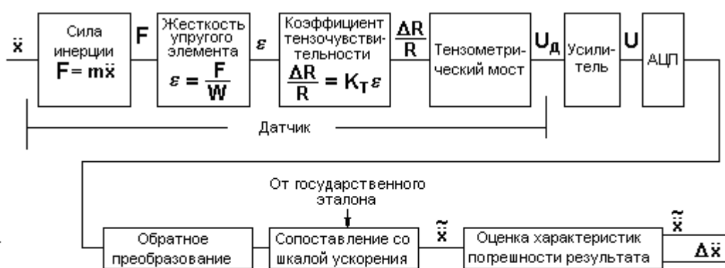
Рис. 23. Измерительные преобразования при измерении ускорения с помощью тензорезистивного датчика
