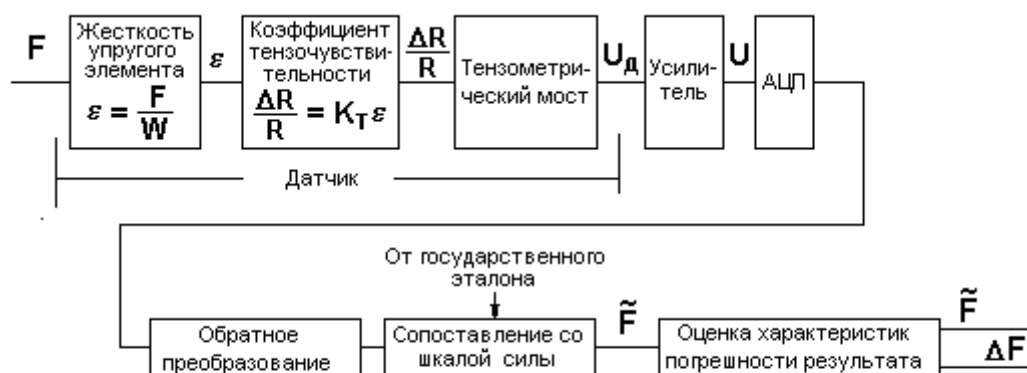
Рис. 21. Измерительные преобразования при измерении силы с помощью тензорезистивного датчика
