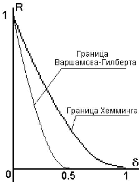
Рис. 11. Асимптотические границы скорости корректирующих кодов
