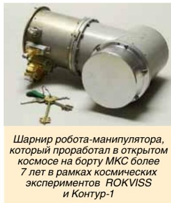
Шарнир робота-манипулятора, который проработал в открытом космосе на борту МКС более 7 лет в рамках космических экспериментов ROKVISS и Контур-1
