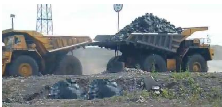
Рис. 2, б. Правый автомобиль с ненормированной перегрузкой по горной массе (различная её кусковатость).
