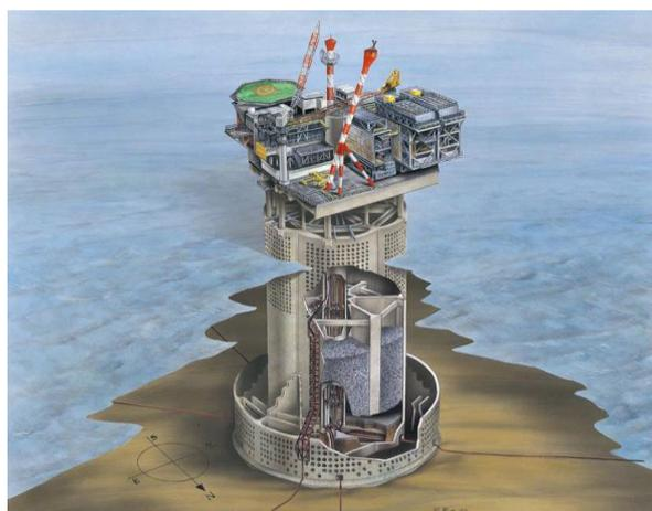
**Рисунок 10. Перфорирование стенок вокруг основного сооружения MCP-01 на месторождении Frigg [29]**
