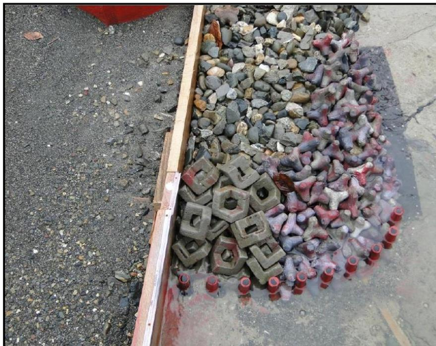
**Рисунок 6. Вид сооружения с упорным рядом свай в конце опыта**
