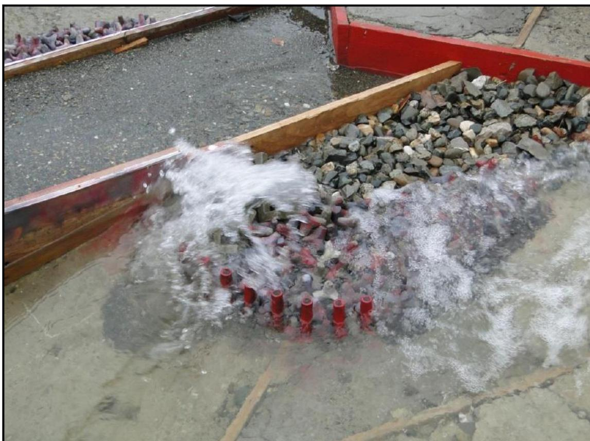
Рисунок 5. Волновое воздействие на сооружение во время опыта с упорным рядом свай
