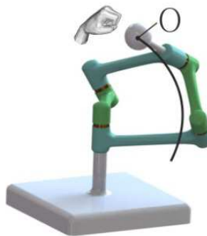
Рис. 3.22 Управление 5R механизмом при помощи инструмента «рука»
