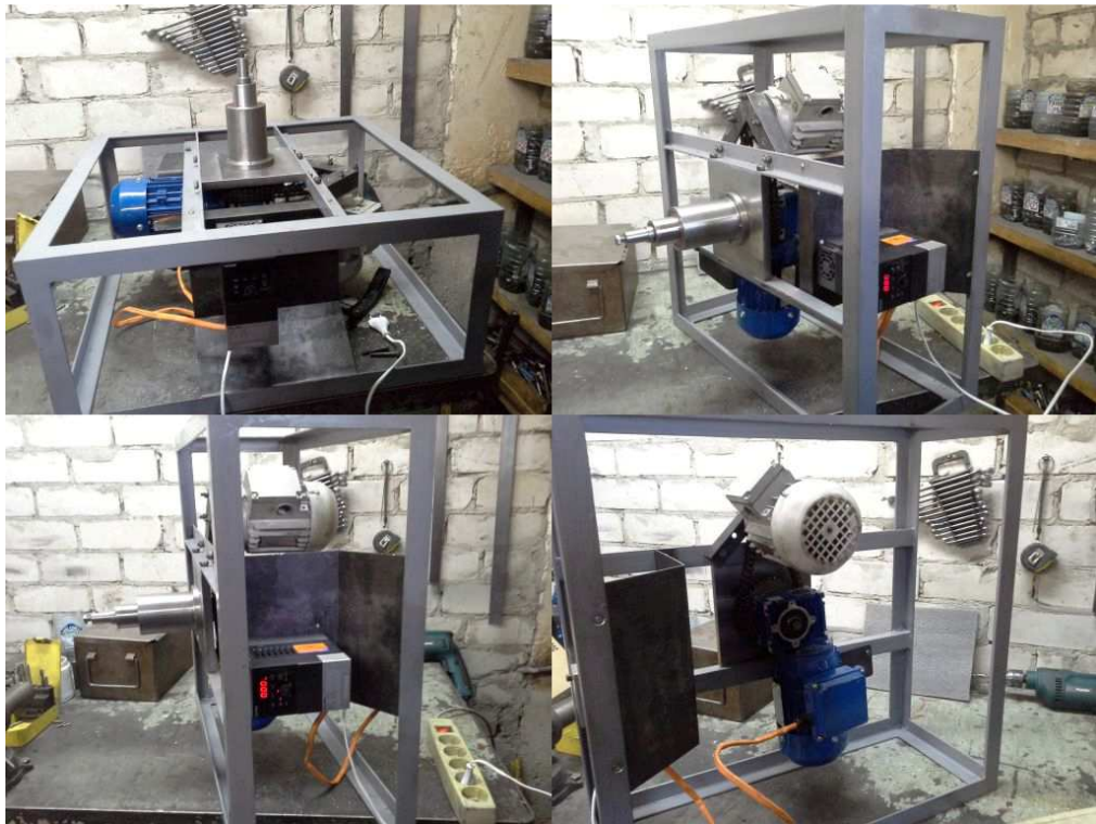
Рис. 4.28 Процесс изготовления многорежимного 3Dмиксера
