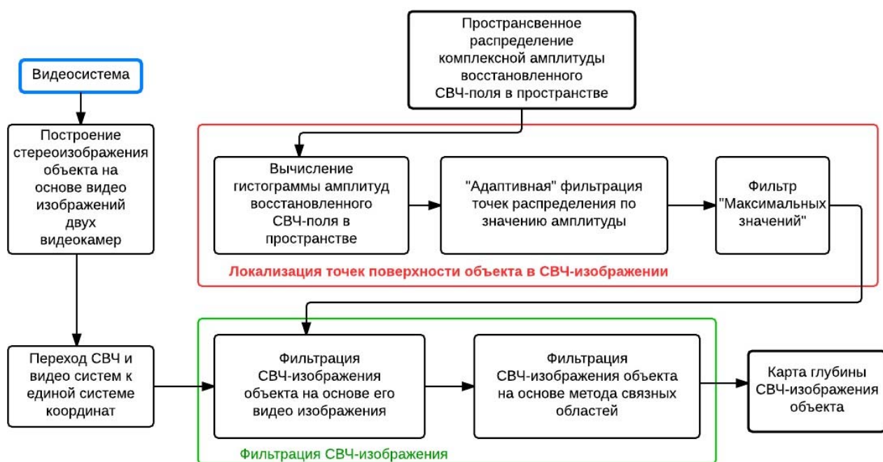
Рисунок 4. Структура метода обработки пространственного распределения комплексных амплитуд СВЧ-поля.
