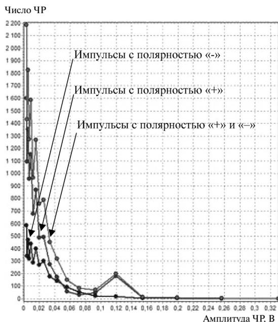
Рис. 4. Статистическое распределение ЧР типов 1 и 2 (увлажненный ПКИ, переменное напряжение 35 кВ; развертка по горизонтали: амплитуда в [1 В] = [10<sup>4</sup> пКл]; развертка по вертикали: число ЧР)
