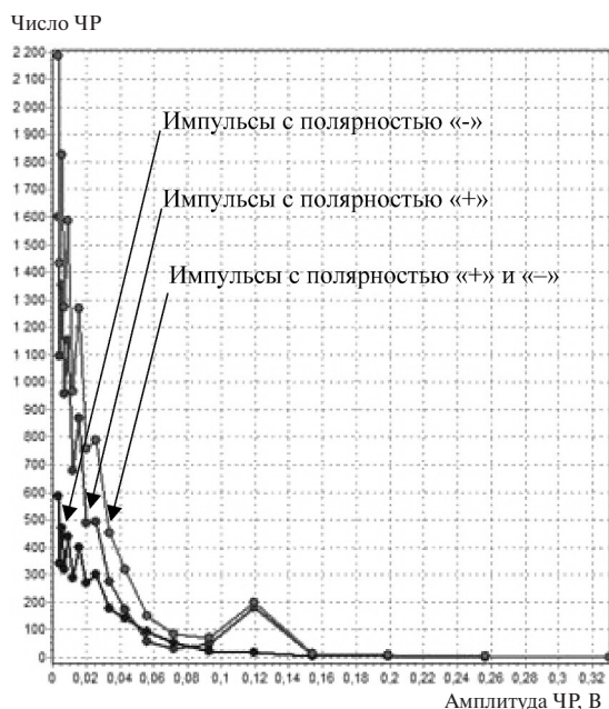
Рис. 4. Статистические распределение ЧР типов 1 и 2 (увлажненный ПКИ, переменное напряжение 35 кВ; развертка по горизонтали: амплитуда в [1 В] = [10 4 пКл]; развертка по вертикали: число ЧР)
