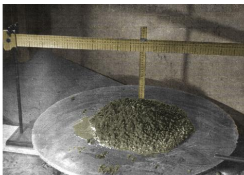
Рисунок 2. Влияние воздухововлекающей поверхностно-активной добавки (марки ЛХД) в комплексе с суперпластификатором на основе лигносульфоната нафталина (марки С-3) 0,8 % на характер пластификации бетонной смеси с расходом цемента 400 (а и б) и 280 (в и г) кг/м 3
