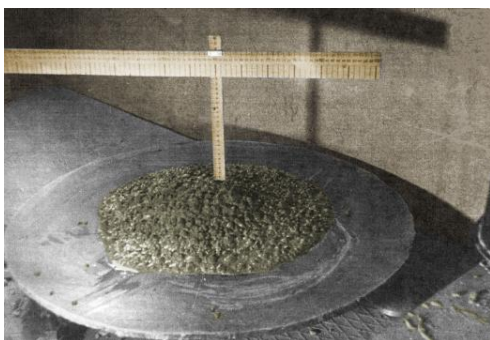
Рисунок 2. Влияние воздухововлекающей поверхностно-активной добавки (марки ЛХД) в комплексе с суперпластификатором на основе лигносульфоната нафталина (марки С-3) 0,8 % на характер пластификации бетонной смеси с расходом цемента 400 (а и б) и 280 (в и г) кг/м 3
