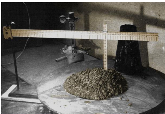
Рисунок 1. Влияние добавки суперпластификатора на основе лигносульфоната нафталина (марки С-3) на характер удобоукладываемости бетонной смеси с расходом цемента 400 кг/м 3
