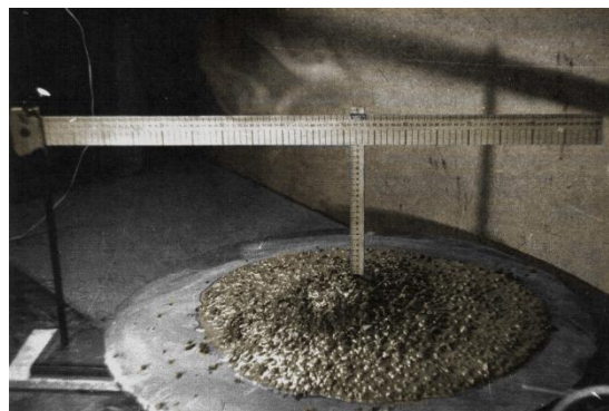
Рисунок 1. Влияние добавки суперпластификатора на основе лигносульфоната нафталина (марки С-3) на характер удобоукладываемости бетонной смеси с расходом цемента 400 кг/м 3
