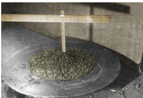
Рисунок 2. Влияние воздухововлекающей поверхностно-активной добавки (марки ЛХД) в комплексе с суперпластификатором на основе лигносульфоната нафталина (марки С-3) 0,8 % на характер пластификации бетонной смеси с расходом цемента 400 (а и б) и 280 (в и г) кг/м 3
