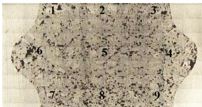
Рис. 17. Макроструктура порошковой заготовки после деформации 45 % (пористость: 1 – 0,259; 2 – 0,201; 3 – 0,234; 4 – 0,287; 5 – 0,226; 6 – 0,268; 7 – 0,262; 8 – 0,340; 9 – 0,247)
