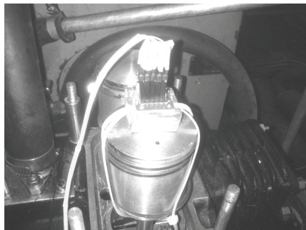
Рис. 6. Поршень с установленным датчиком
