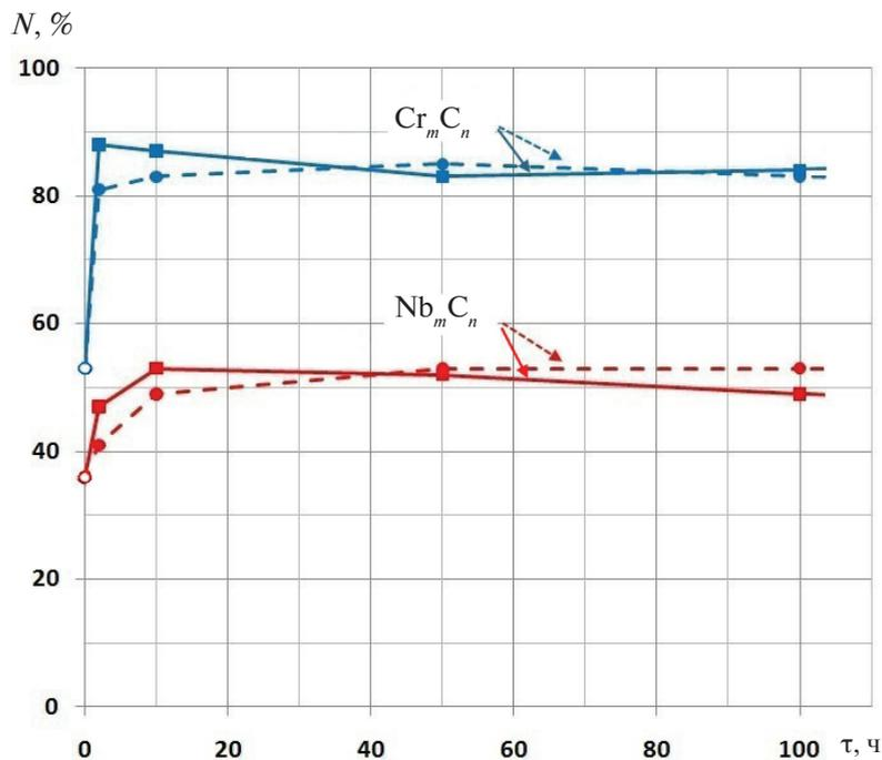
Рис. 5. Изменение относительной доли включений карбидов хрома  $Cr_mC_n$  и ниобия  $Nb_mC_n$  средним диаметром менее 2 мкм в общем количестве включений соответствующей фазы в структуре литого (о) сплава 0,45C-26Cr-35Ni-2Si-2Nb в зависимости от длительности выдержки при 1150 °C и скорости охлаждения с печью (—■—) или в воде (•---•)
