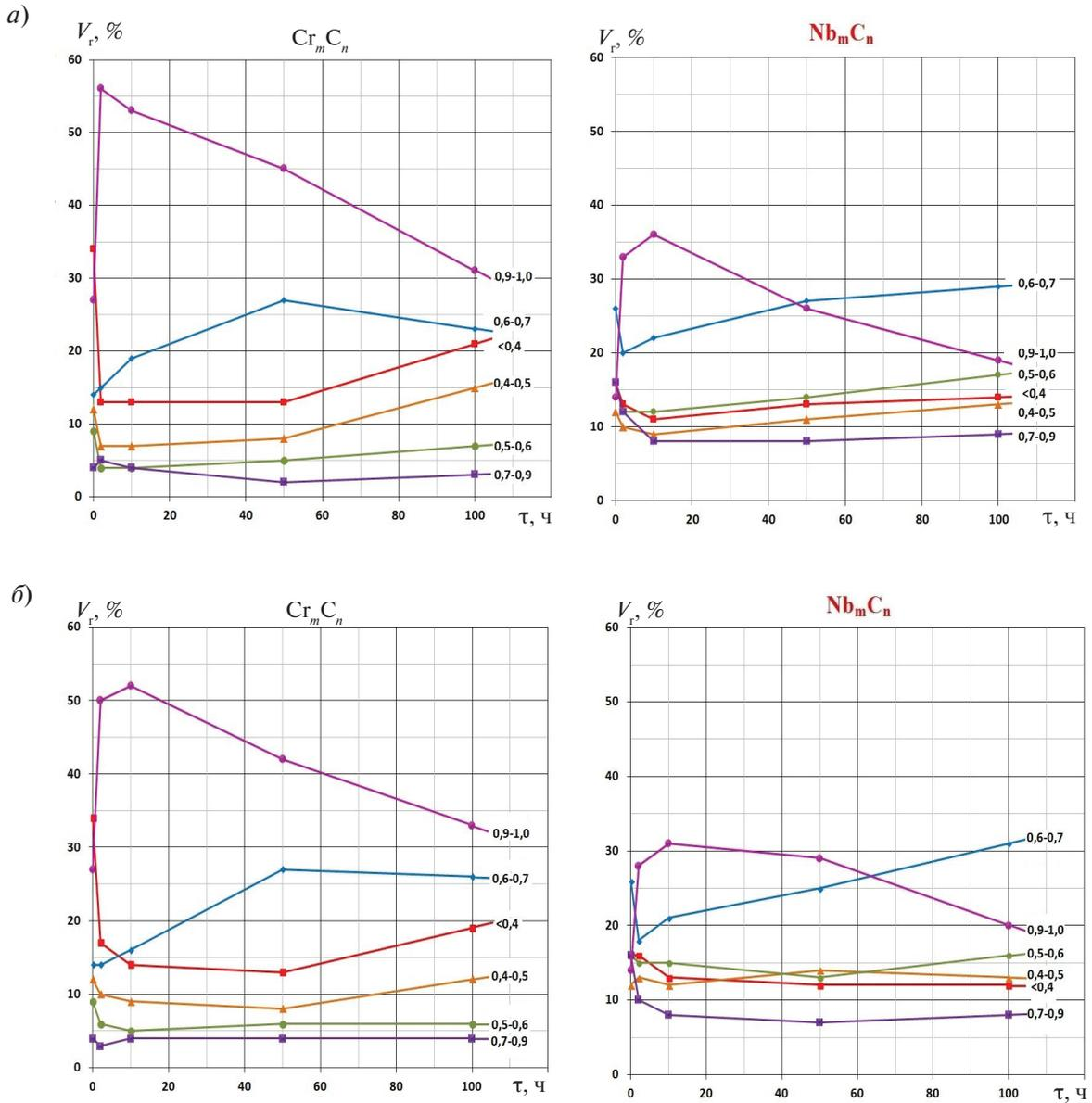
Рис. 4. Изменение относительной доли включений карбидов хрома  $Cr_m C_n$  и ниобия  $Nb_m C_n$  разной округлости в общем объеме соответствующей фазы в структуре литого сплава 0,45С-26Cr-35Ni-2Si-2Nb в зависимости от длительности выдержки при 1150 °С и скорости охлаждения с печью (а) или в воде (б). Цифры у кривых – величина округлости  $r$
