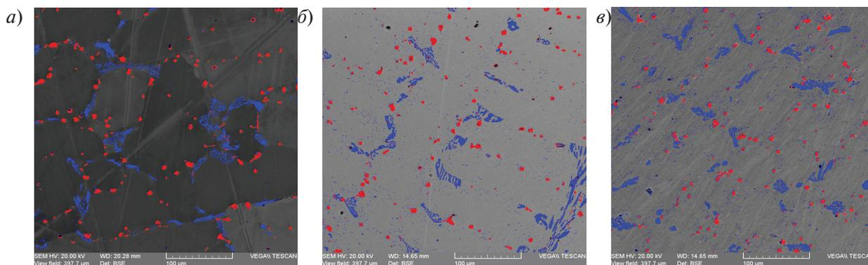
Рис. 6. Структура сплава 0,45C-26Cr-35Ni-2Si-2Nb в литом состоянии (а) и после выдержки 2 ч при 1150 °C с охлаждением с печью (б) или в воде (в):  $Cr_mC_n$  (синие частицы),  $Nb_mC_n$  (красные частицы),  $\gamma$ -фаза (серая матрица). РЭМ
