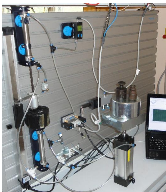
Рисунок 8. Экспериментальная установка для испытаний двухцилиндрового пневмоприводного вакуумного насоса.
