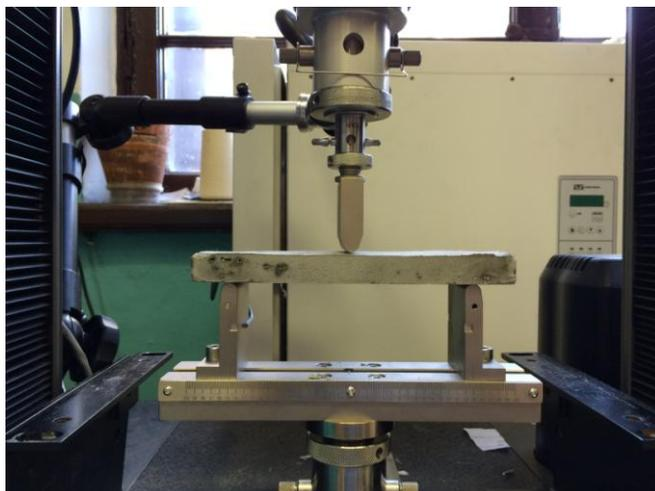
Рисунок 2. Испытание армированного образца на трехточечный изгиб
