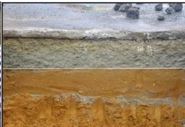
**Рисунок 2. Копирование деформации основания тонкослойным покрытием (дорожная одежда кольцевого стенда Нантского университета) [1]**
