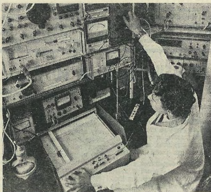
Из года в год наш институт заключает со многими научно-производственными объединениями страны договоры о сотрудничестве. Этот снимок сделан на кафедре электрической изоляции, кабелей и конденсаторов во время проводимых исследований электрофизических свойств тонких диэлектрических пленок в многослойных системах типа МДП по договору с ленинградским НПО «Позитрон». Фото К. ПЕТРОВА
