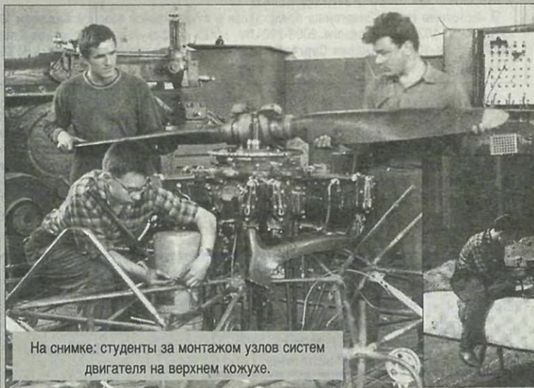
На снимке: студенты за монтажом узлов систем двигателя на верхнем кожухе.
