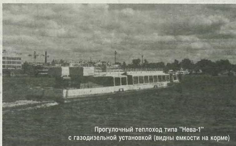
Прогулочный теплоход типа "Нева-1" с газодизельной установкой (видны емкости на корме)
