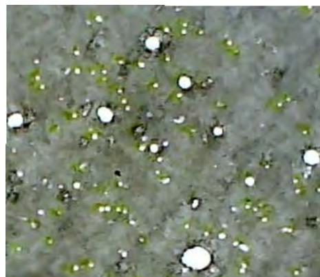
Рисунок 2. Следы прожога каплями металла нетканого полизэфирного фильтрующего материала на расстоянии 200 мм от сварочной горелки
