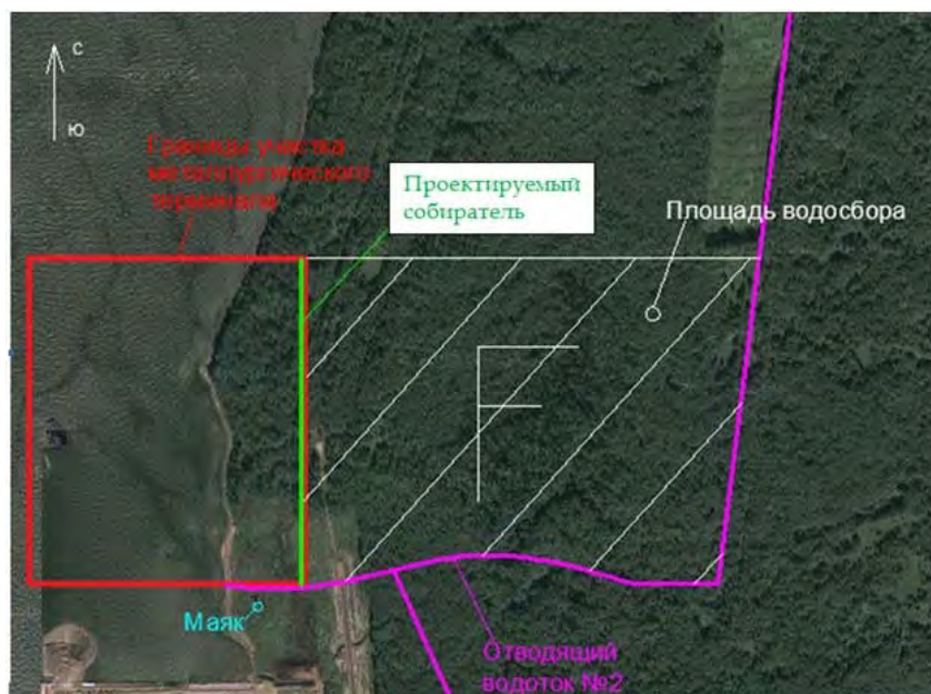
Рисунок 8. Схема к определению площади водосбора
