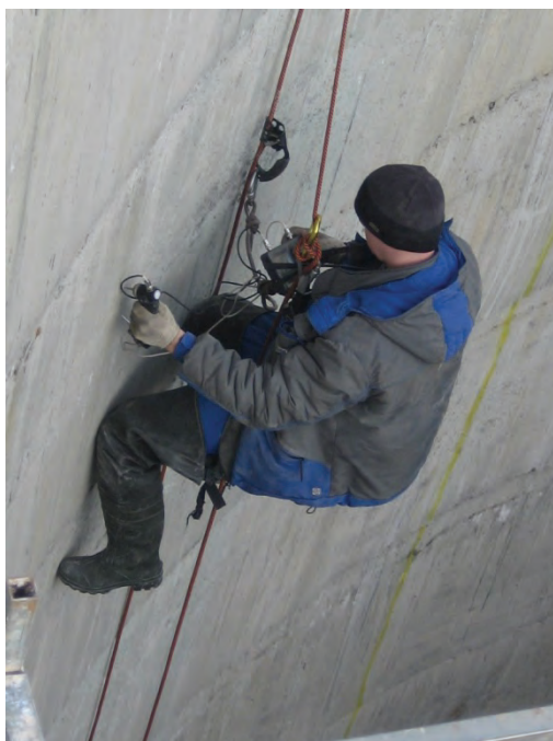
Рисунок 2. Измерения ультразвуковым методом Рисунок 3. Измерения методом упругого отскока
