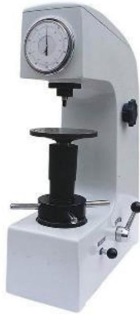
Рис.4.1. Стационарный твердомер по методу Роквелла.
