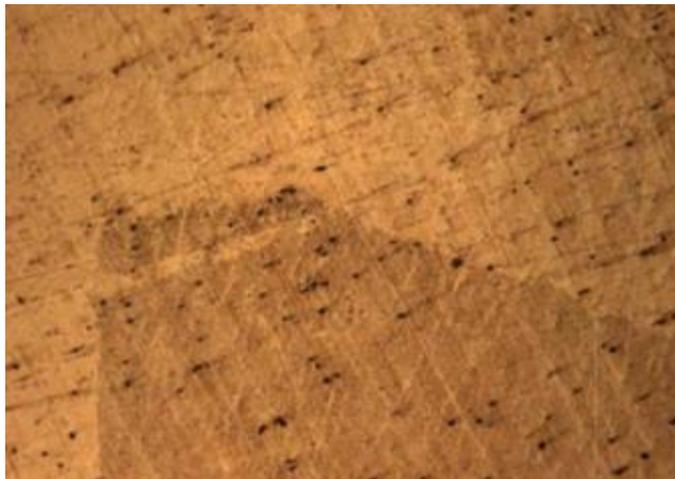
Рис.3.16. Вдавленный в поверхность шлифа абразив.
