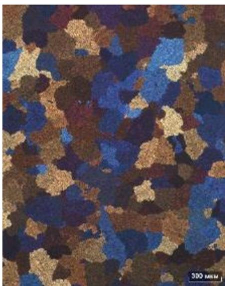
Рис.9.12. Вид структуры алюминиевого сплава при использовании поляризованного света с  $\lambda$ -пластиной.
