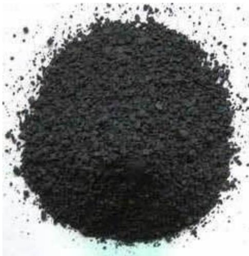
Рис.3.8. Фенольная смола для горячей запрессовки металлографических шлифов.
