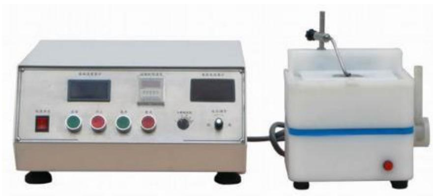
Рис.8.2. Ячейка для электрохимического травления.
