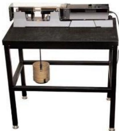
Рис.4.7. Станок для испытаний на изгиб при вращении.
