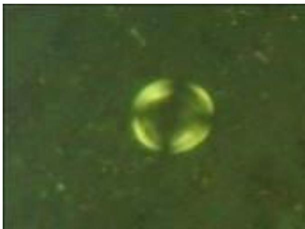
Рис. 9.11. Силикатное включение в стали при наблюдении в поляризованном свете.
