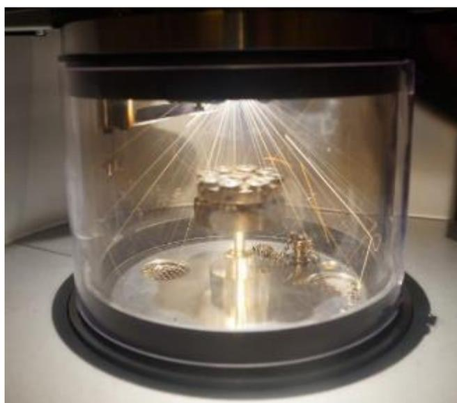
Рис.10.3. Вакуумная камера для покрытия образцов углеродом.
