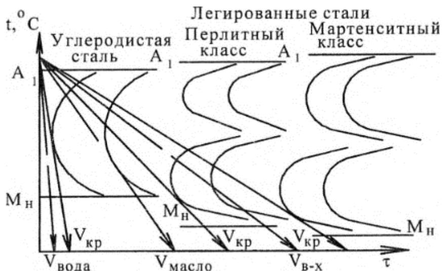
Рис.2.2. Диаграммы изотермического превращения аустенита в сталях [4].
