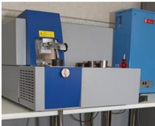
Рис.5.2. Оптико-эмиссионный спектрометр.
