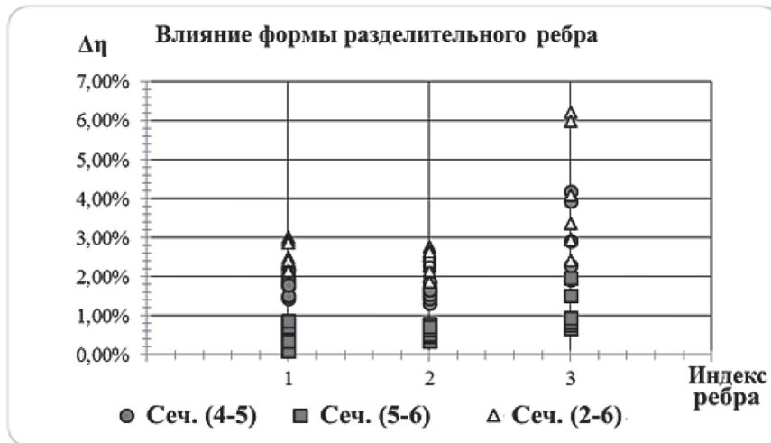
Рис. 5. График распределения потерь КПД в КСК в масштабе компрессора при 3 формах разделительного ребра: № 1, 2 – неполное ребро № 3 – полное ребро
