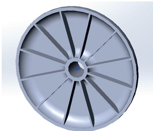
*Рис. 9.* Модель рабочего колеса СВН
